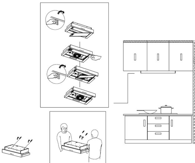
5) Saque la corredera e instale el filtro de grasa de nuevo en la corredera, luego empújelo en la campana extractora e instale el otro filtro de grasa.
