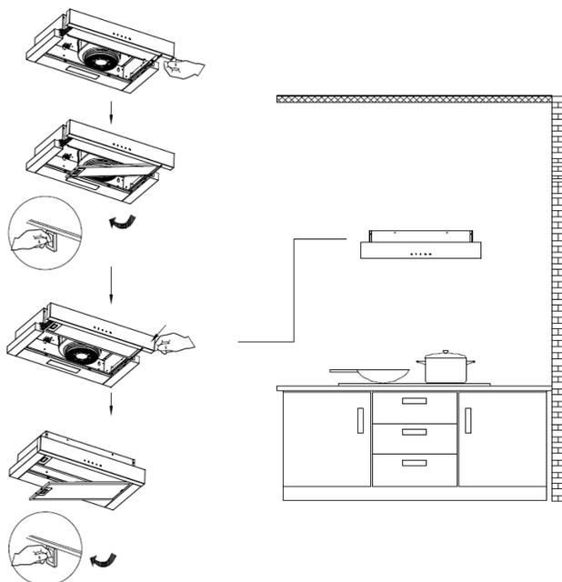
6) Conecte la alimentación y saque la diapositiva. A continuación, encienda/apague las luces LED para comprobar si las funciones funcionan correctamente.
